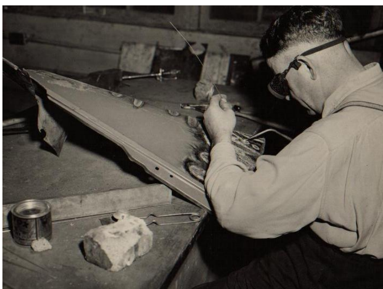
Figura 1.1: Sudare cu flacără oxiacetilenică (reparare șasiu), 1949
