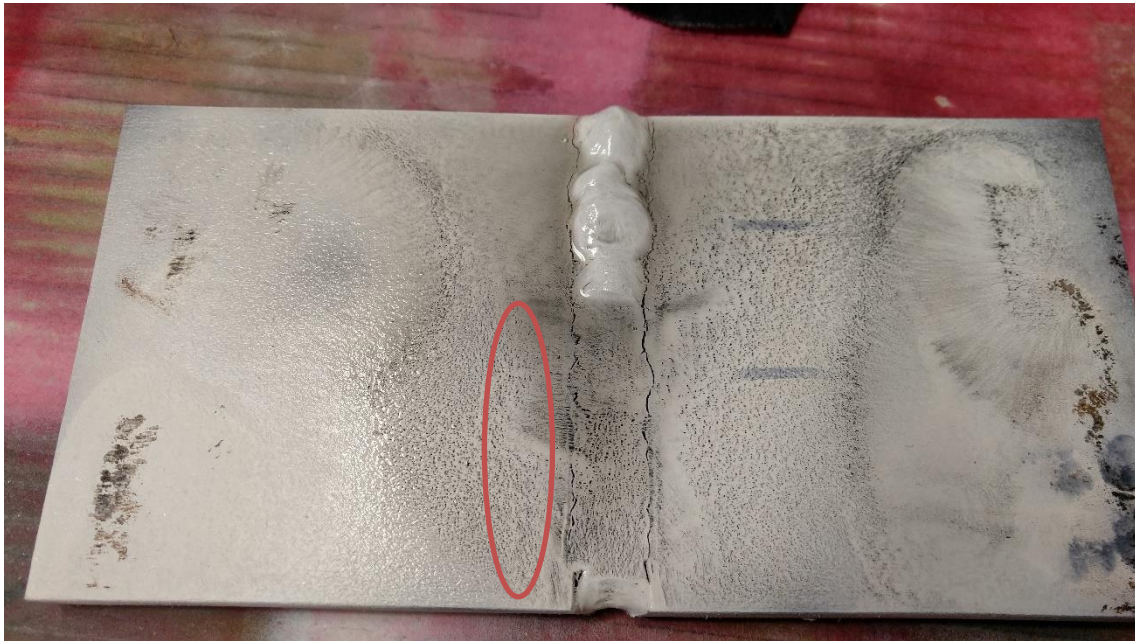
Fig.6. Rezultatele unui test de particule magnetice pe o sudură cap la cap care a fost parțial prelucrată (cerc roșu).
