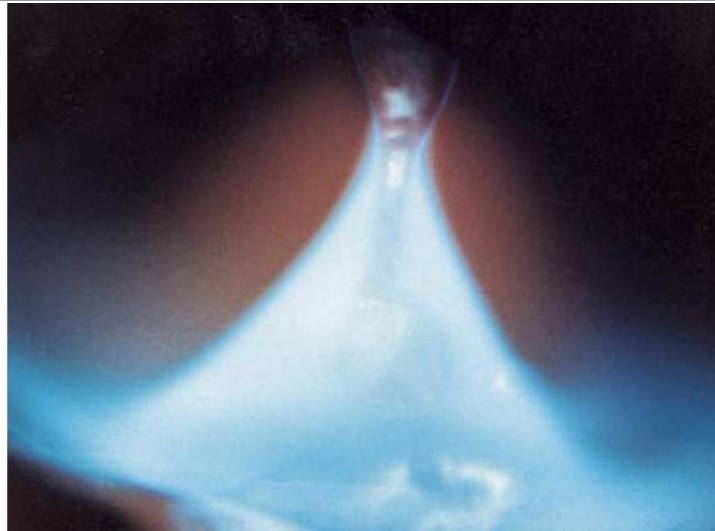
Fig.21: Modul de transfer prin pulverizare
