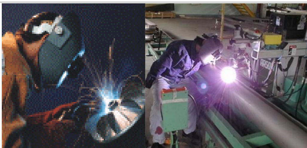
Fig.3: Sudarea semi-mecanizată și mecanizată
