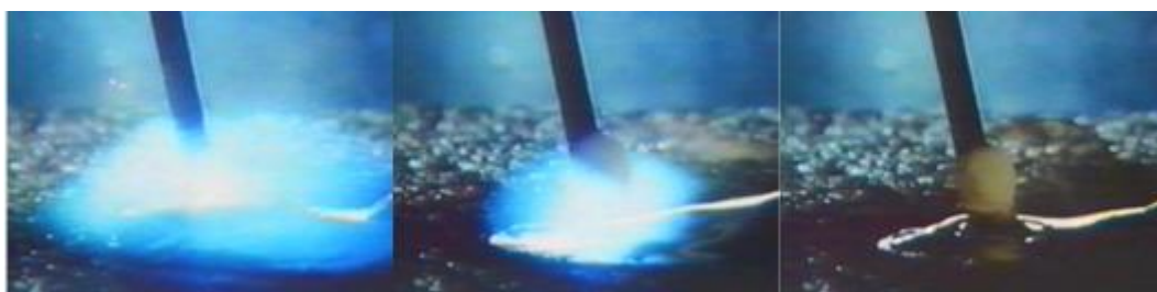
Fig.21: Modo de transferência por arco curto
