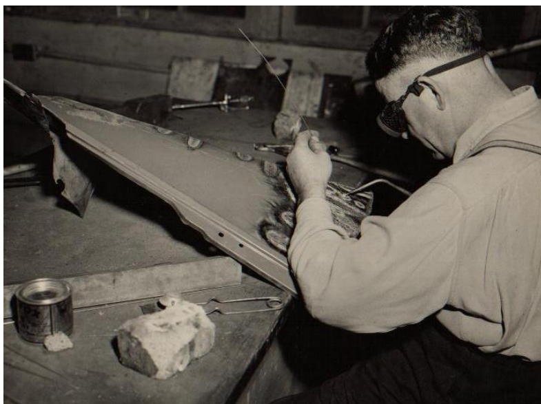
Figura 1.1 Soldadura oxiacetilénica a gás (reparação de chassis), 1949
