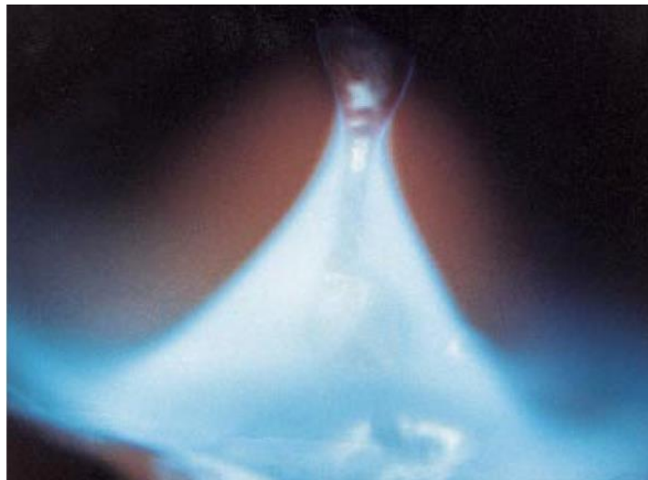
Fig.23: Modo de transferência por arco spray
