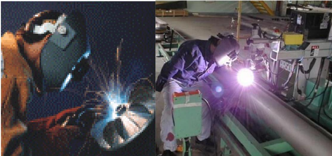
Fig.3: saldatura parzialmente meccanizzata e fully meccanizzata
