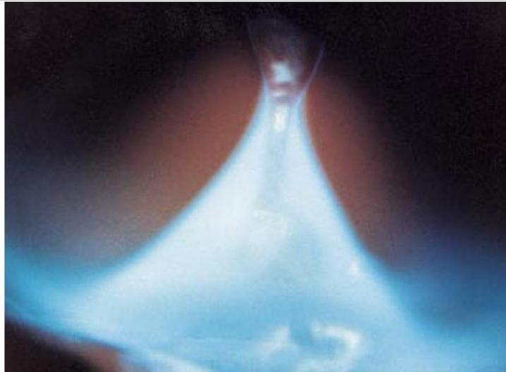
Fig.21: modalità di trasferimento spray arc
