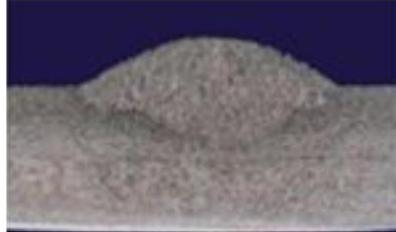
Fig.16: saldatura con He
