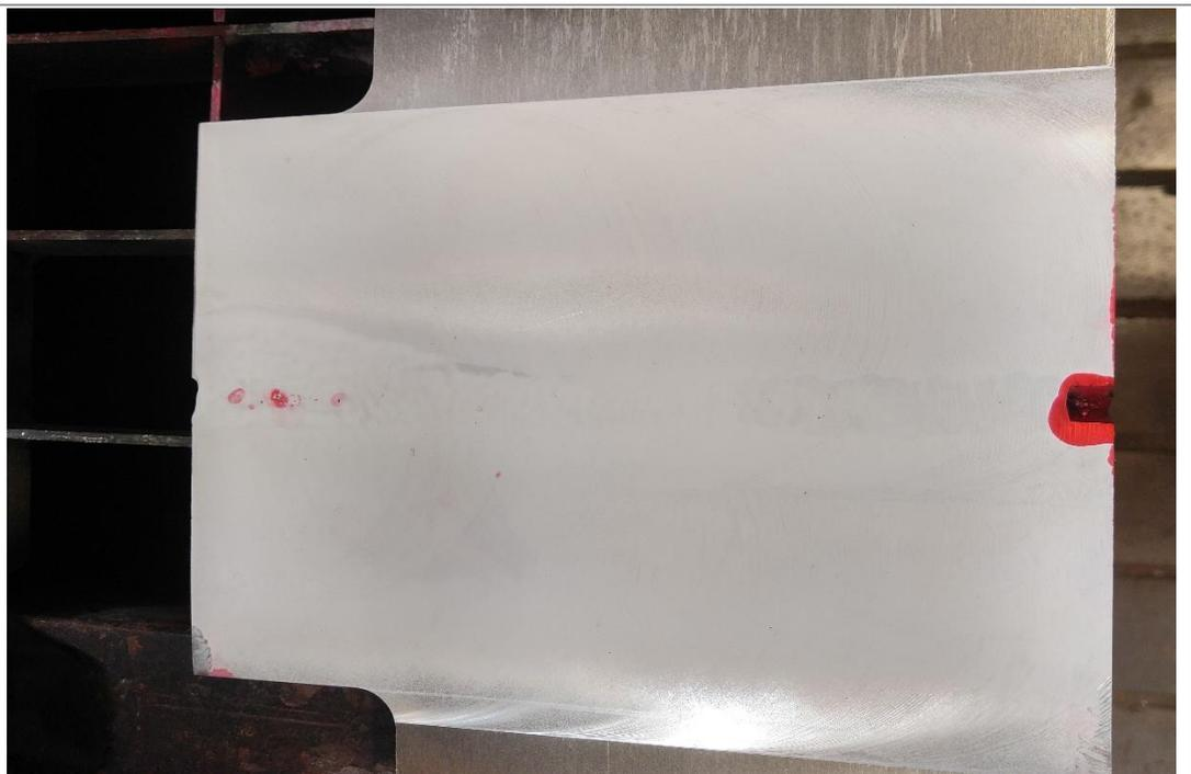
In questa immagine possiamo vedere i risultati di una prova di penetrazione dello stampo su una saldatura di testa in alluminio che è stata lavorata.
