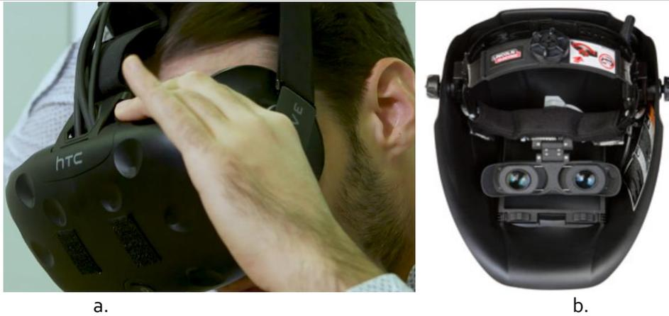
Fig. 3.8 Display per simulatori di saldatura VR
