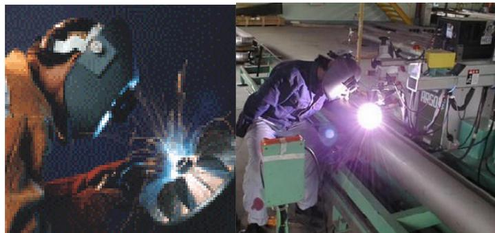
Imagen.3: soldadura parcialmente mecanizada y completamente mecanizada
