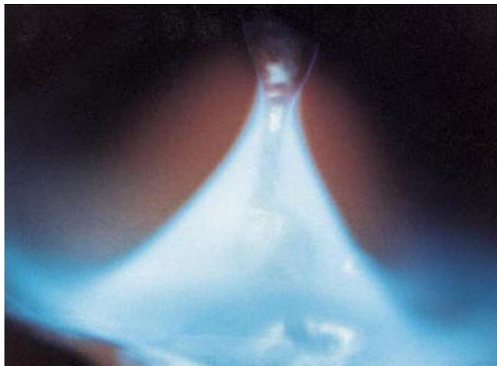
Imagen.21: Transferencia arco de pulverización
