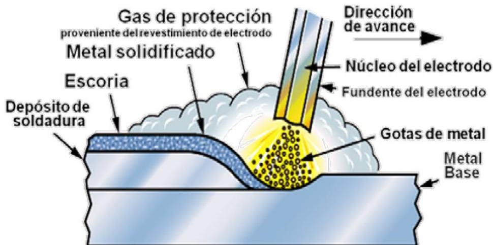
*Imagen 1. Proceso de soldadura utilizando electrodos revestidos*
