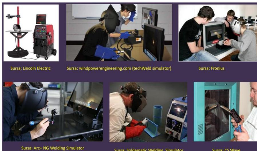
Figura. 1.3 Simuladores de soldadura [1]
