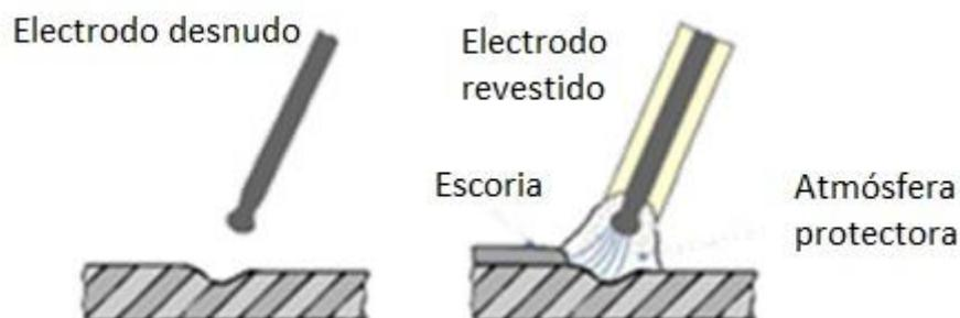
*Imagen 9: Diferencias entre los electrodos con y sin revestimiento*
